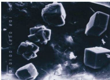
Bild 1 zeigt die Schnittfläche einer unbehandelten Kontrollprobe unter einem Rasterelektronenmikroskop.
