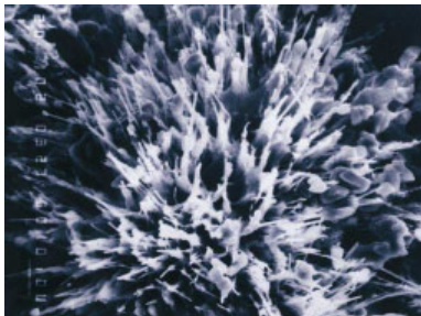
Bild 3 entstand nach 26 Tagen, das intensive Wachstum der XYPEX-Kristalle ist deutlich sichtbar.
