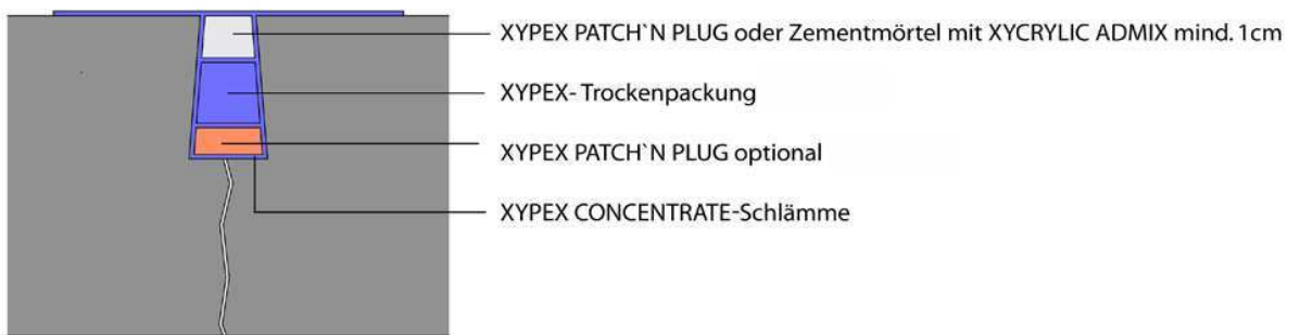
Detailskizze Trockenpackung erhöhte Anforderung
